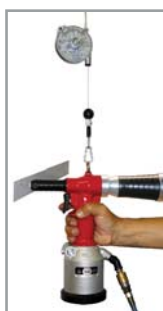
Applicazione attacco superiore How to use the upper hook
