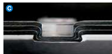
Steel 0.7 mm Adhesive 2 x steel 0.7 mm
